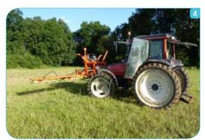
La vitesse d'avancement est directement dépendante de la densité des tiges à couper et liée à la différence de hauteur entre graines indésirables et culture implantée (plus la différence est marquée, plus l'imprécision de conduite possible est grande, plus la vitesse d'avancement est élevée). Le débit horaire évolue entre 1 et 3 ha par heure suivant les modèles avec un travail qui se réalise fréquemment "par tâches".
